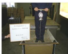
コンクリート製U字溝に締め固めた土砂。コーン指数を計測
