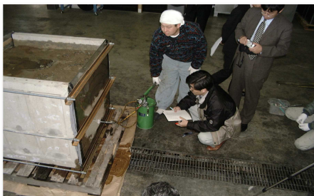
● 土砂圧によって、アクリル版と土砂の間を拡散する膜伸びを確認
