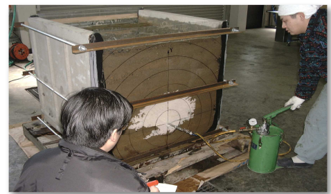
● ドリル孔に注入プラグを取付け、圧入開始
